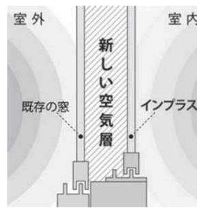
新しく内窓を設置することで、既存の窓との間に『空気層』を作り、外気温の影響を受けにくくします。今ある窓にプラスするだけなので、あっというまの一日施工です!
