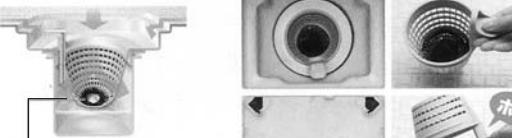
従来の排水口は、毛髪がヘアキャッチャーに絡みつき、水の流れが悪くなります。そこに皮脂などを含む汚れた水が滞留し、汚れを発生させ、増殖させています。「くるりんポイ排水口」なら、うずの力で髪やゴミをまとめるので、髪やゴミが水の流れをふさがずスムーズに流れ、汚れが発生にくくなります。
